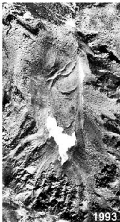
Développement d'une instabilité de type glissement dans la partie terminale du glacier rocheux Grueo1 dans le Grübträlli,
