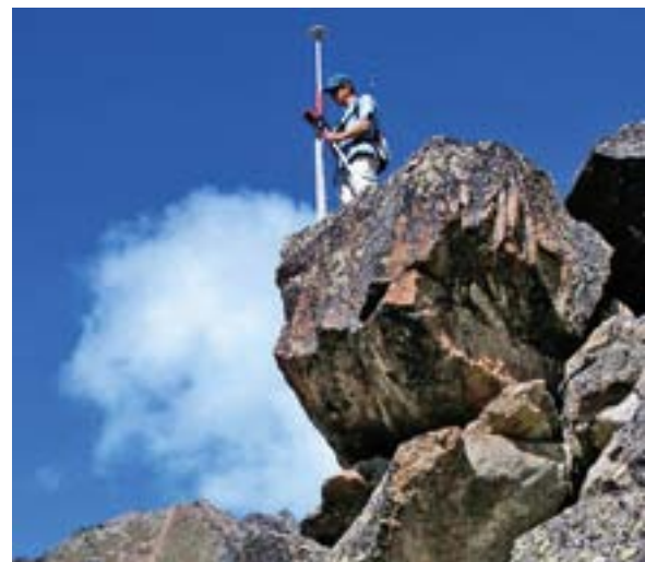
Relevés GPS sur les éboulis en mouvement du glacier rocheux de Tsarminne [Arolla/VS].
