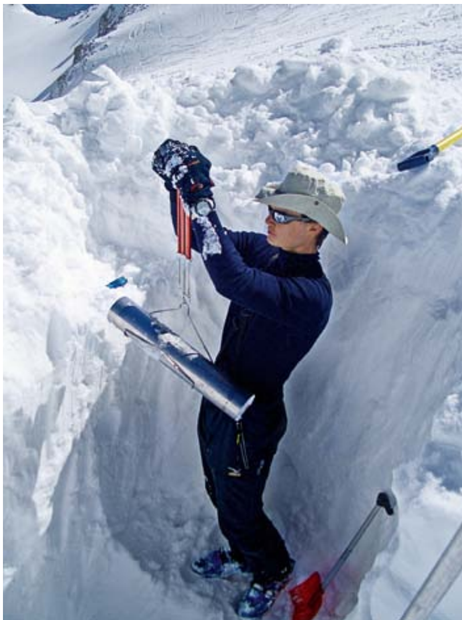
Mesure de l'épaisseur de la neige au Pizogletscher. Photo : Mauro Werder
